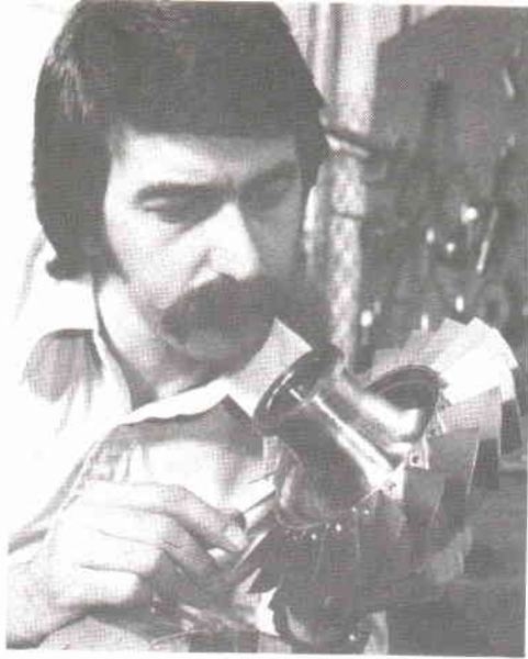
Kontroll av en axialkompressor till en liten gasturbin vid P & W of Canada.
